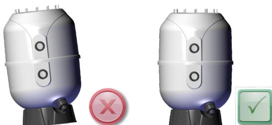
3.2- Vervollständigen Sie den Ventilanschluss mit dem mitgelieferten Zubehör, indem Sie die Klebevorgänge ausführen. Achten Sie darauf, die O-Ringe und Anschlüsse nicht mit dem Kleber zu verschmutzen, und prüfen Sie, ob das 6-Wege Ventil perfekt ausgerichtet ist.
