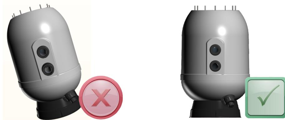
3.2- Vervollständigen Sie den Ventilanschluss mit dem mitgelieferten Zubehör, indem Sie die Klebevorgänge ausführen. Achten Sie darauf, die O-Ringe und Anschlüsse nicht mit dem Kleber zu verschmutzen, und prüfen Sie, ob das Sechswegeventil perfekt ausgerichtet ist.
